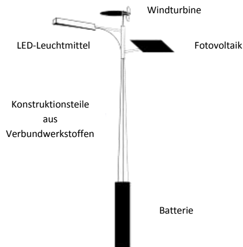
Bild 13 – Eine LED-Hybridlampe, die für die Straßenbeleuchtung eingesetzt wird
