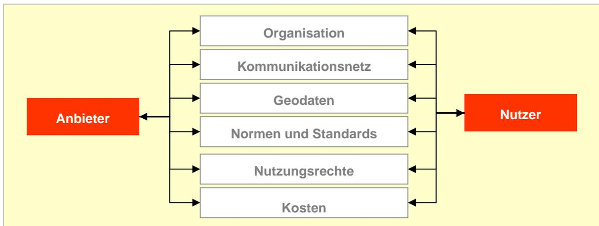
Abbildung 8: Komponenten einer Geodateninfrastruktur
